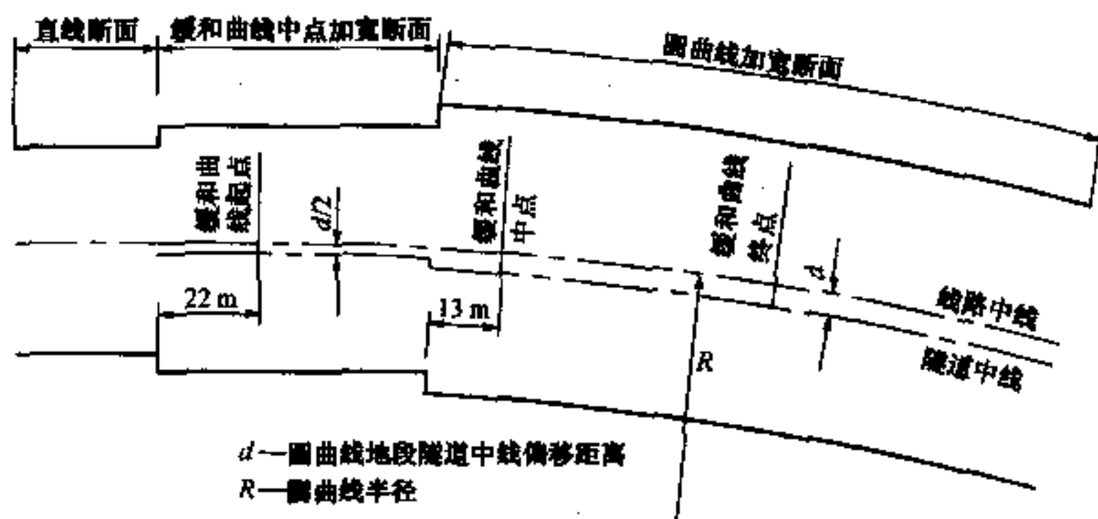
图 7.1.4 曲线地段隧道加宽示意图
