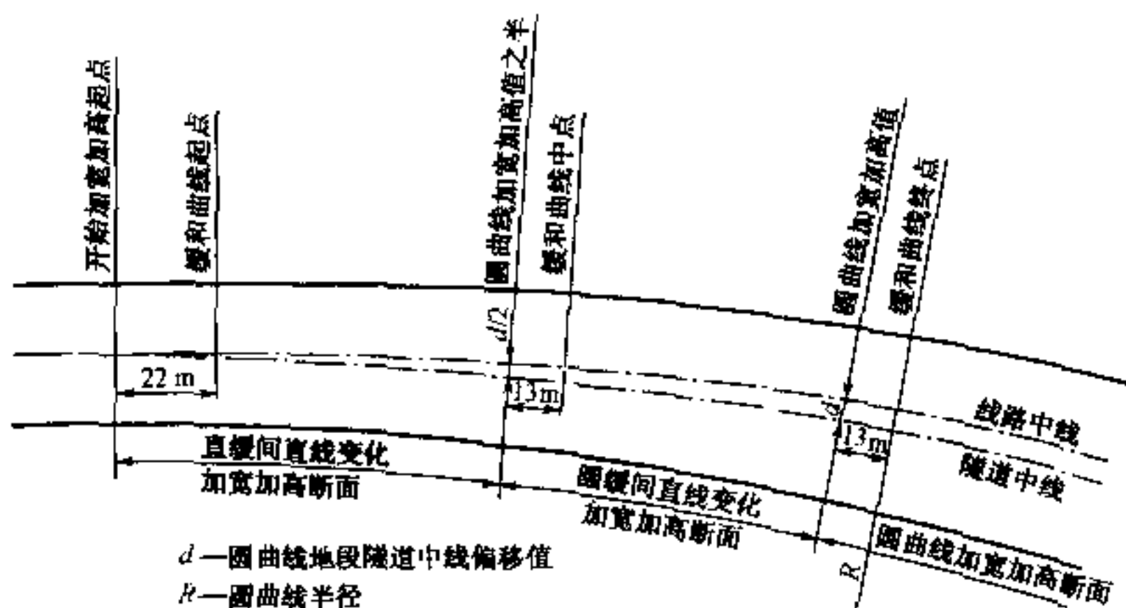
图 15.2.2 改建曲线地段隧道加宽加高示意图
